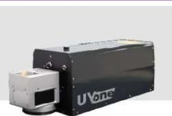
O comprimento de onda do laser UV de 355 nm é versátil para a marcação de uma ampla variedade de materiais e perfeito para aplicações de "marcação a frio" nas quais não são permitidas zonas afetadas pelo calor – essa máquina é ótima para marcar plásticos e materiais de silicone sem aditivos e pode marcar vidro com um risco reduzido de microfatura. O pequeno ponto de feixe de alta qualidade possibilita a micromarcação de precisão com resolução extremamente nítida.
