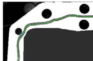
BeadInspect™ Inspeção de camadas de selante
